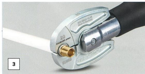
Pozicionirati alat za presovanje pod pravim uglom u odnosu na spoj i do krajeve press čaure, pa izvršiti
